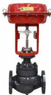
Válvula de control neumática de asiento único 1 1/2" -150 LB Cuerpo A216 WCB Empaque PTFE
