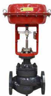
Válvula de control neumática de asiento único 2 1/2" - 150 LB Cuerpo A216 WCB Empaque PTFE
