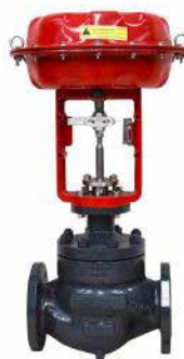
Válvula de control neumática de asiento único 1 1/2" -150 LB Cuerpo A216 WCB Empaque PTFE
